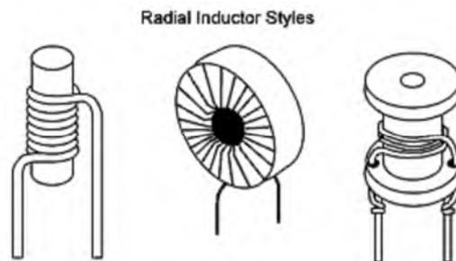
徑向電感的形式：棒形、環形、線軸形
