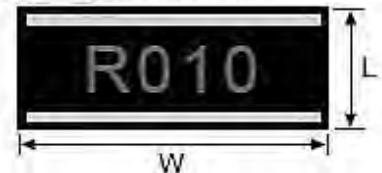
貼片低阻毫歐電阻 CS 系列 尺寸圖
