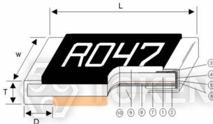
金屬片電流感應貼片電阻器 (CSM)
