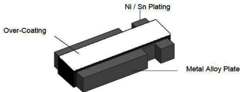
四端子電流檢測貼片電阻器 (LRF)
