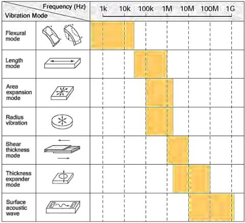
陶瓷譜振器振動模式 (彎曲模式,長度模式,面積擴展模式,半徑振動, 剪切厚度模式,厚度擴展模式,表面聲波) 和頻率範圍
