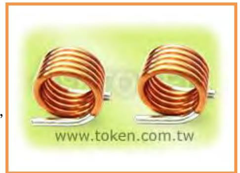
德鍵 (TRAD) 的電感量不會受它所攜帶的電流所影響。而傳統使用的鐵氧體磁芯線圈的電感量在中等磁場強度會達到峰值飽和，電感量於飽和前下降接近於零。小型 (TRAD) 空芯線圈系列，具有更好的品質因數，更高效率，更大的功率處理，最高可能的自諧振頻率 SRFs，並減少失真。
