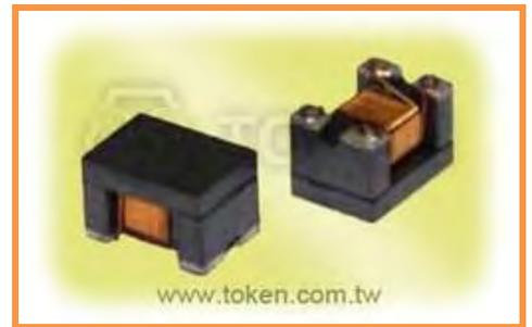
貼片式(TCPWCH-4532AU)具有超薄厚度 2.8mm，為減小體積、降低成本；四個電感值，方便選擇；低阻抗的線圈和嚴格的公差，可依要求定制設計。兼容汽車所需工作溫度  $-40^{\circ}\text{C}$  to  $+125^{\circ}\text{C}$ 。
