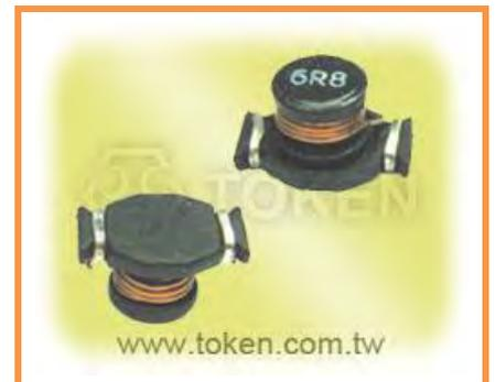
TPU1813DHP 採用先進的繞線技術，堅固耐用的直接線端之構造可實現大電流，較低的直流阻抗 DCR 和小於 5.0mm 的厚度。TPU1813DHP 的電感值為 0.18  $\mu$ H to 100  $\mu$ H，額定電流高達 14.00 A。
